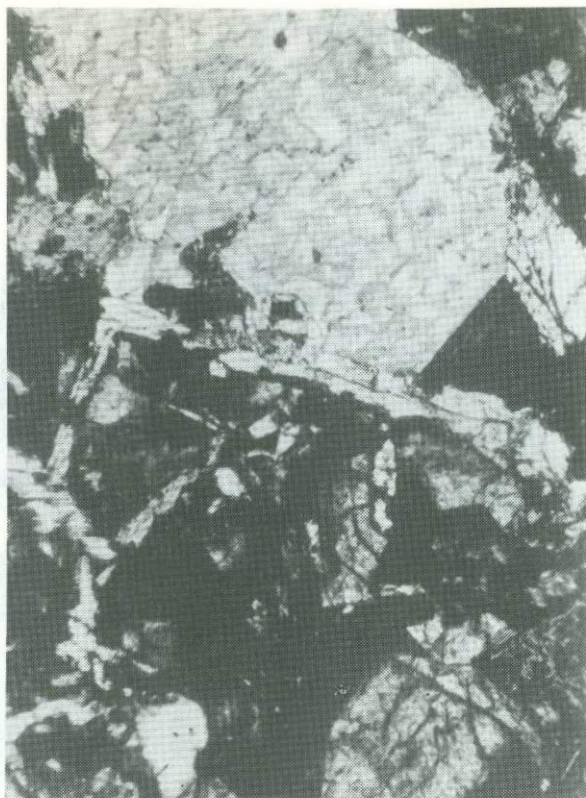
Р и с. 8. Крупные незамещенные кристаллы геденбергита, расположенные по периферии карбонатного обломка, замещенного датолитом, корродируются гранатом Прозрачный шлиф, увел. 27
