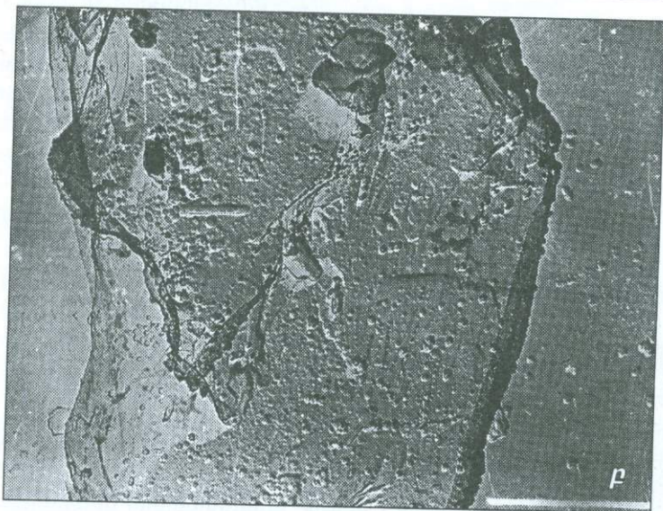
Նկ. 2.6. ա-Պոլիմերով հագեցված տուֆի կոտրվածքը լուսային մանրադիտակում, բ-փակ ծակոտիները տուֆերում (էլեկտրոնային մանրադիտակ):
