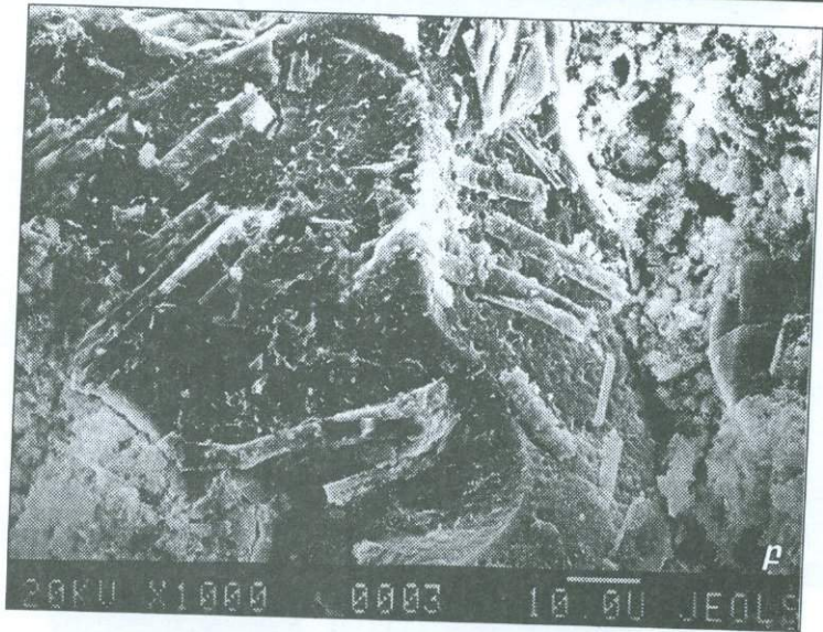
Նկ. 5.8. Կրաշաղախների միկրոկառուցվածքը սկանային էլեկտրոնային մանրադիտակում. ա-հիդրոգելենիտի բյուրեղներ, բ-ասեղնաձև, պրիզմատիկ բյուրեղների հարաճուճը տուֆի ավազի հատիկի վրա:
