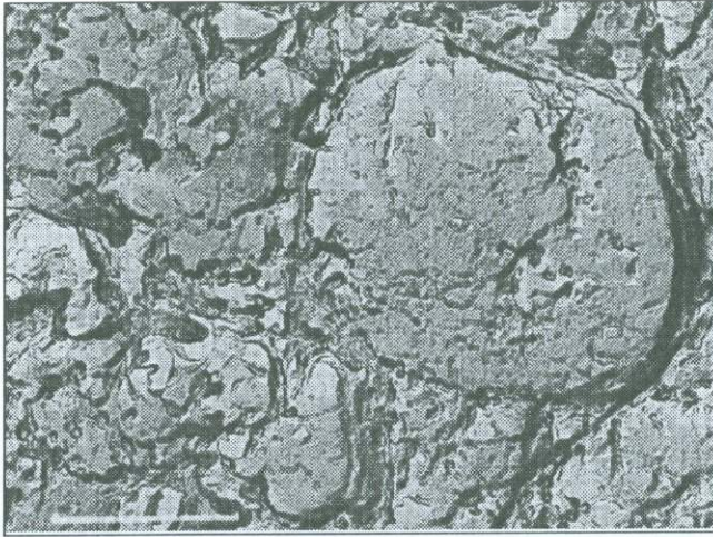
Նկ. 5.6.-ի շարունակությունը: տուֆի մակերևութից անջատած կրային բաղադրիչի միկրոկառուցվածքը թափանցող էլեկտրոնային մանրադիտակում (Pt/C ռեպլիկա):
