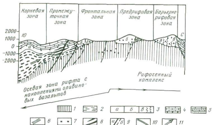
Р и с. 8. Схема сочленения эвапоритового рифтогенного бассейна и его ограничивающего рифтогенного комплекса (разрез с позицией составных частей рудоносной системы); положение разреза дано на рис.7
