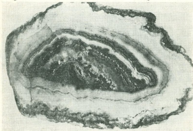
Рис. 3. Тонкополосчатое чередование свободного кремнезема с редкой вкрапленностью пирита и полос с мелкими кристаллами пирита и блеклой руды.
