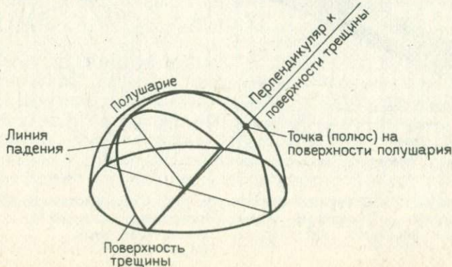
Рис. 50. Схема, поясняющая соотношение поверхности полушария и трещины
