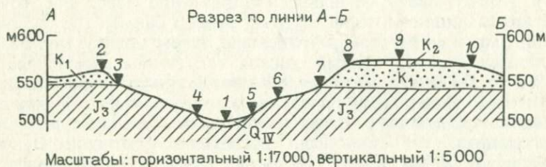
Рис. 83. Пример оформления работы по построению геологического разреза и определению превышений
