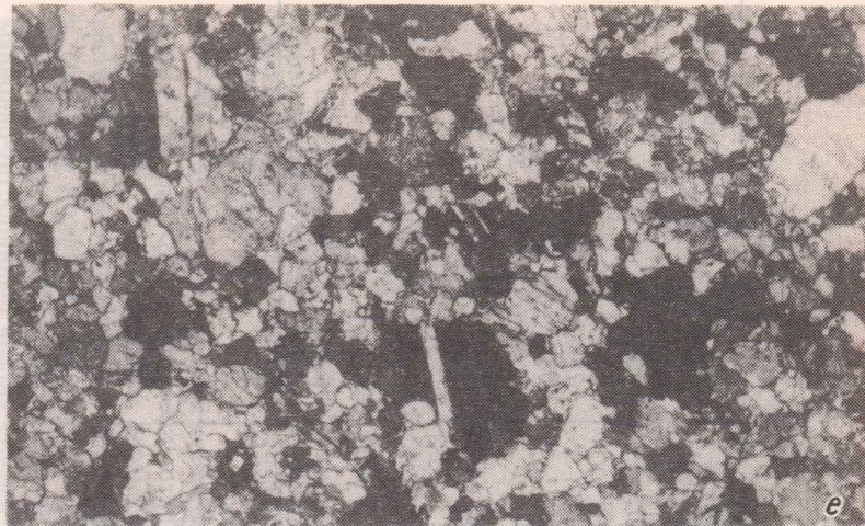
Рис. 1. Исходный мрамор (а) и мрамор, перекристаллизованный при 150 °С (б), 200 °С (в), 250 °С (г), 300 °С (д), 400 °С (е) и 500 °С (ж). Шлиф, николи скрещены, увел. 45.
