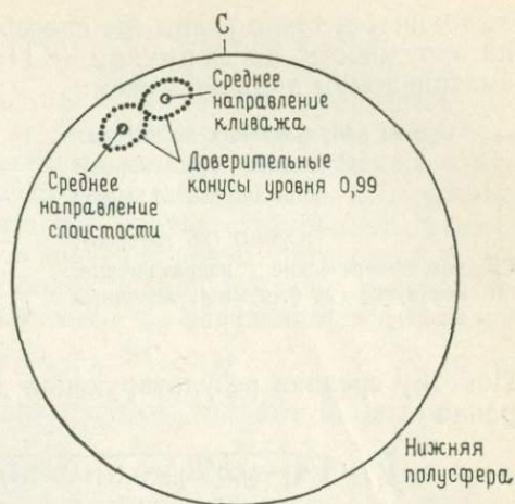
Рис. 9.7. Доверительные конусы уровня 0,99, построенные на равноплощадной проекции для данных, приведенных в табл. 9.2. Подробнее о методике построения см. в тексте.
