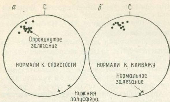
Рис. 9.5. Направленные вниз нормали к плоскостям слоистости (а) и кливажа (б) в южношотландской граувакковой формации силурийского возраста. Черные точки — нормали к слоям в опрокинутом залегании или к нижним поверхностям кливажа, крестики — нормали к слоям в нормальном залегании или к верхним поверхностям кливажа.
