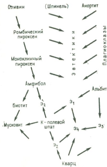
Рис. 25. Схема соотношений главнейших минералов в магматическом расплаве. По А. Н. Заварицкому
