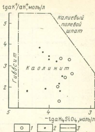
Рис. 15. График зависимости \lg aK^+ / aH^+ от -\lg aH_4SiO_4 для подземных вод в природных условиях. 1—2 — в отложениях (1 — ратынских, 2 — литотамниевых); 3 — граница полей устойчивости минералов
