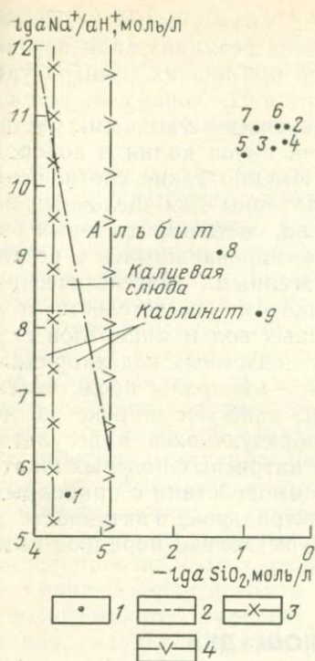
Рис. 34. График зависимости \lg a_{\text{Na}^+}/a_{\text{H}^+} от -\lg a_{\text{SiO}_2} для подземных вод промышленной площадки.
