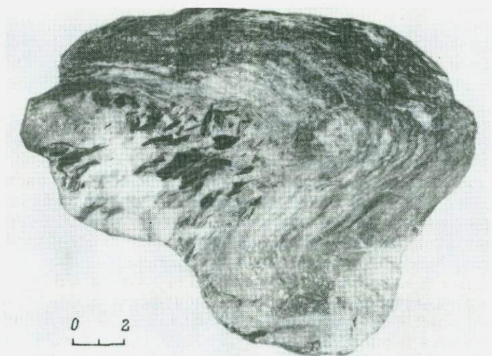
Рис. 7. Крупночешуйчатый молибденит (идиоморфнометазернистая структура), секущий зону контакта жилы и вмещающих сланцев и кристаллизовавшийся после формирования складки и дробления жилы. Жила Главная.
