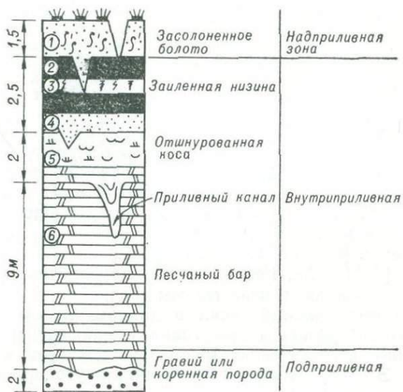
Рис. 39. Гипотетический разрез последовательности осадочных образований в разных зонах приливо-отливной равнины [78].
