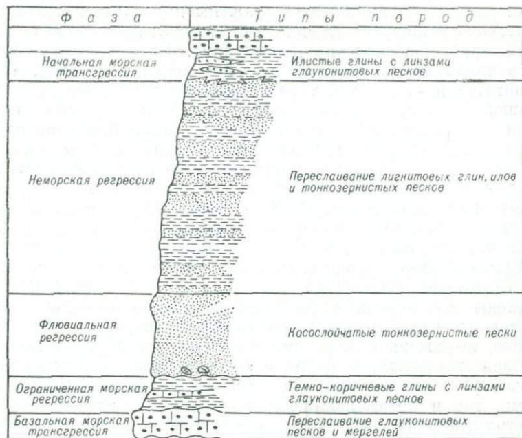
Рис. 34. Луизианский тип эоценовых терригенных циклов, западная и центральная части штата Луизиана, США (W. L. Fischer [73]).
