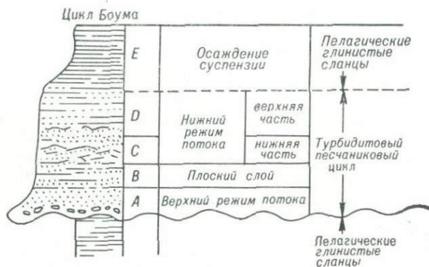
Рис. 55. Совершенный турбидитовый цикл А. Боума и интерпретация осадков с позиций изменения режима потока [46].
