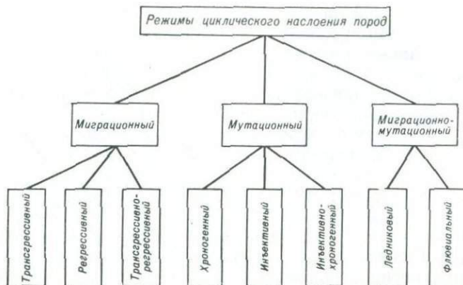
Рис. 13. Классификация режимов образования элементарных седиментационных циклов.
