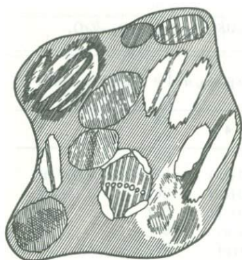
Р и с. 18. Кристаллы карнегита в системе Ne-ZrO_2
