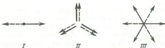
Рис. 27. Три типа (I–III) спиновых структур, возможных в пирротинах
