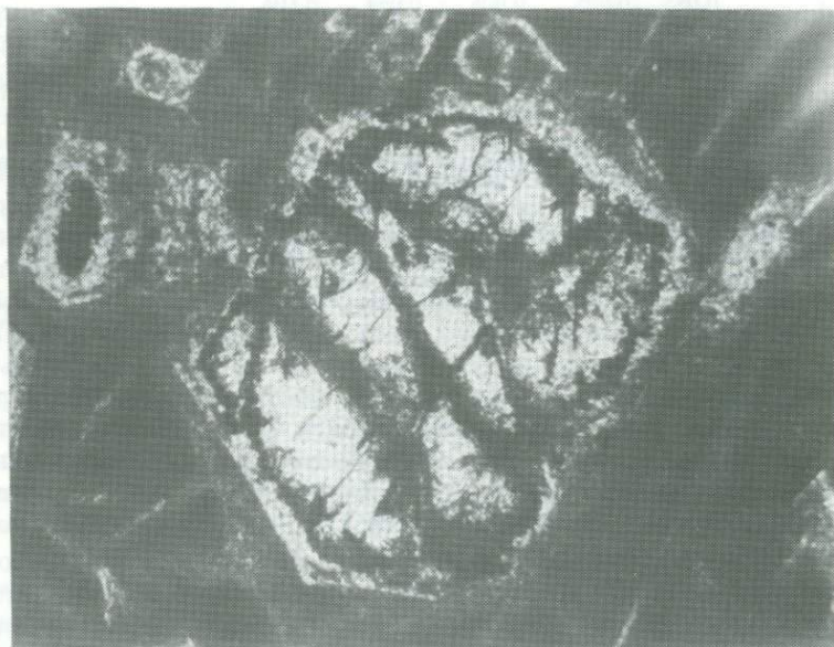
Рис. 31. Хорошо сохранившееся зерно магматического оливина в коматиитовом базальте обр. 1782 со слабой серпентинизацией по краям и трещинам (проходящий свет, без анализатора, увел. 60)
