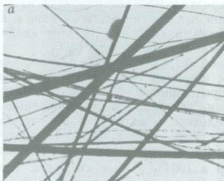
Рис. 44. Электронно-микроскопическое изображение фторкупферита: а — суспензия, ув. 13000; б — платиноугольная реплика, ув. 25000
