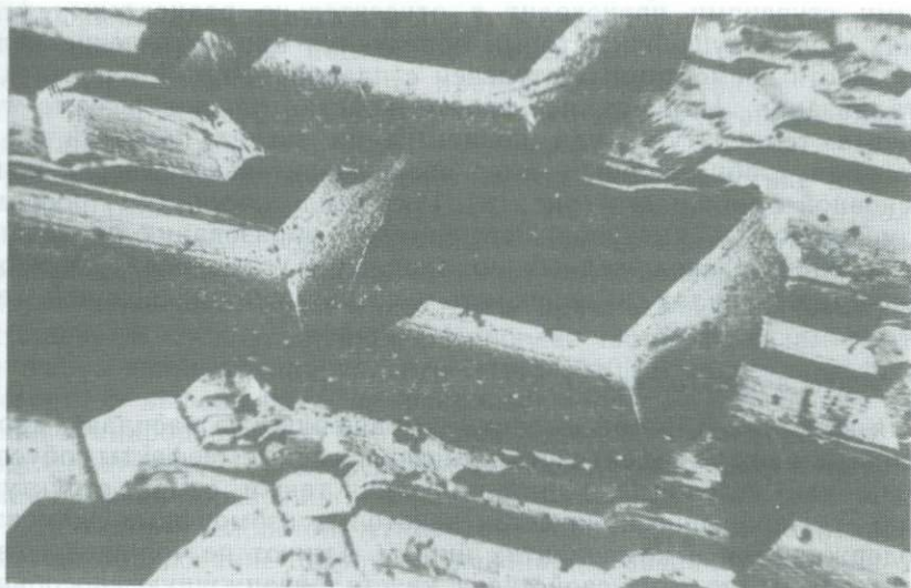
Рис. 17. Характер ступенчатой поверхности роста в плоскости (001). Ув. 100
