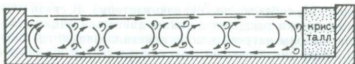
Рис. 61. Схема распределения потоков в горизонтальной лодочке с горизонтальным градиентом температуры по данным модельного опыта с прозрачной жидкостью [18]
