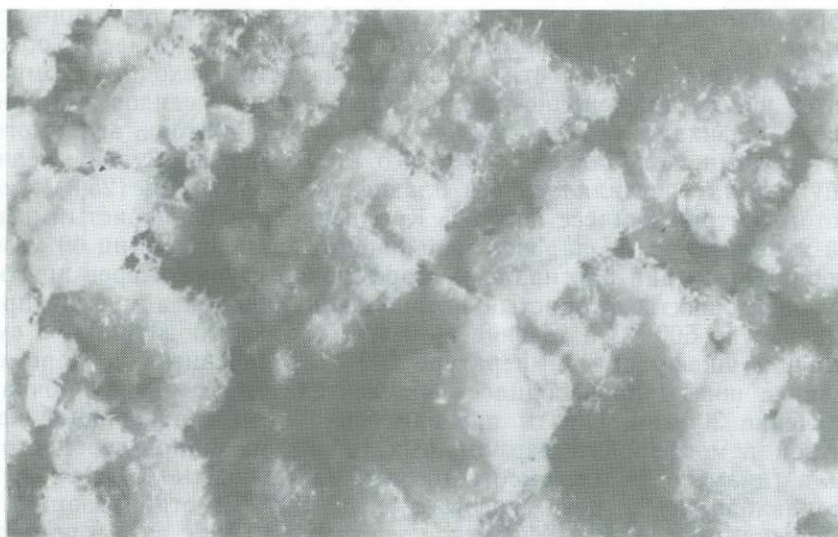
Рис. 40. Внешний вид кристаллов фторрихтерита. Ув. 20
