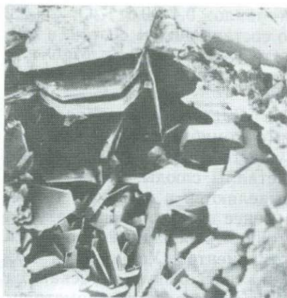
Рис. 5. Поликристаллический сросток слюды, полученный из раствора в расплаве фторидов. Нат. вел.
