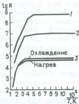
Рис. 168. Графики температурных зависимостей сопротивления образцов, легированных мышьяком в присутствии в шихте Ti и In:
