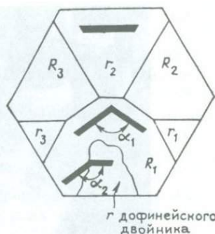
Рис. 24. Схема бразильских двойников на гранях R , r и при переходе бразильского двойника в дофнейский.
