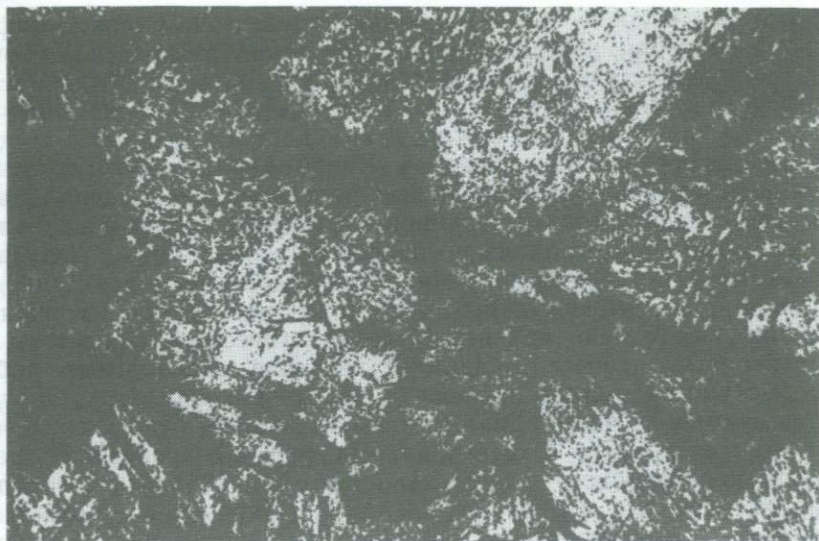
Рис. 85. Характерный вид трещины КРН на стенке сосуда из стали 25X2МФА Ув. 100
