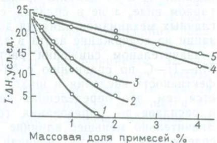
Рис. 151. Содержание парамагнитного азота в кристаллах в зависимости от концентрации примесей в шихте:
