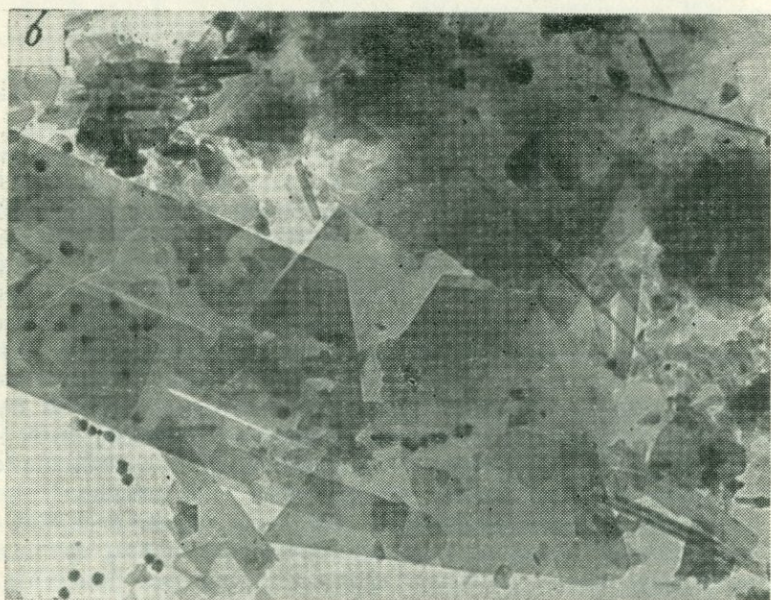
Рис. 26. Электронные микрофотографии триоктаэдрического хлорита с небольшой примесью изометрично-пластинчатой гидрослюды (а) и ди-триоктаэдрического хлорита с примесью удлиненно-пластинчатой гидрослюды (б — см. рис. 25, б):
