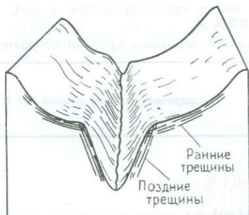
Рис. 6. Соотношение ориентировки трещин разгрузки с рельефом в известняках района Вайонт (Италия)
