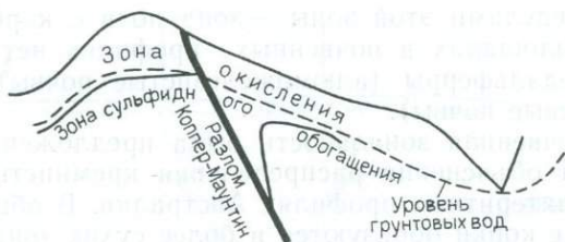
Рис. 81. Схематический разрез зоны окисления сульфидных руд на месторождении Коппер-Маунтин, Моренси, штат Аризона (США).
