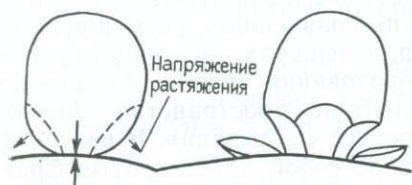
Рис. 11. Образование пестикообразных и линзовидных валунов при наложенной трещиноватости под действием силы тяжести
