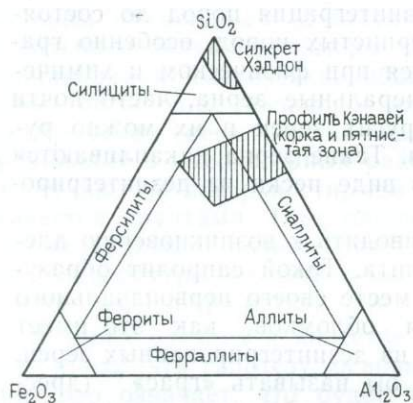
Рис. 95. Классификация твердых корок (панцирей) на треугольной диаграмме составов. По Г. Дьюри [173]. Положение силкрета Хэддон и профиля Кэнавей приведено по Б. Сениору и Дж. Маббуту [514]
