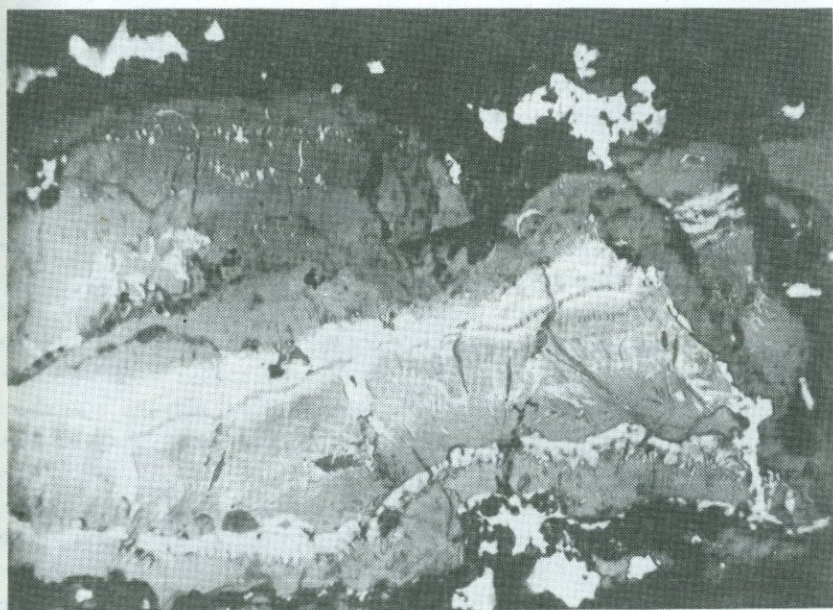
Р и с. 2. Ритмично-полосчатая иордизит-настуритовая корка пересекается галенит-настуритовой коркой. Полир. шлиф, увел. 165
