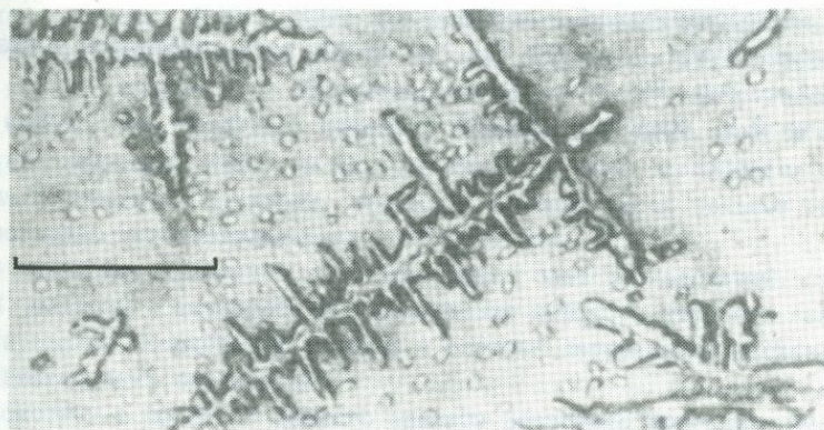
Р и с. 10. Дендритная структура сополимера диэтилового эфира винилфосфиновой кислоты с акриловой кислотой (по В.А.Каргину и Г.Л.Слонимскому /1/)
