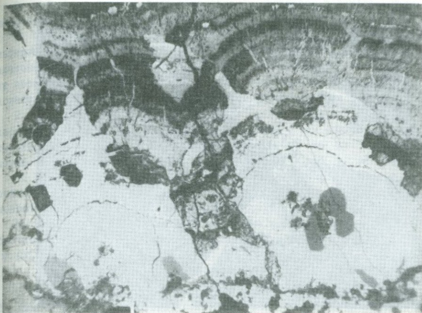
Р и с. 7. Строение настуран-сфалеритового прожилка. Иордизит-настурановые сферолиты нарастают на сферолиты сфалерита и замещают их. Полир. шлиф, увел. 165
