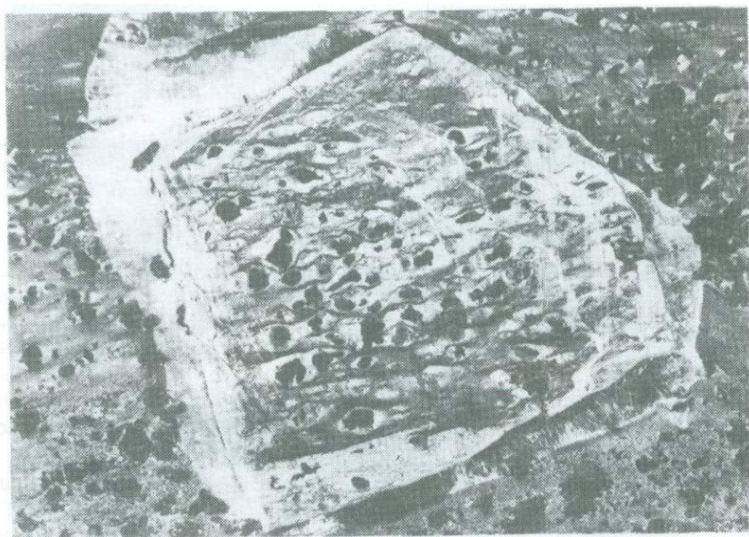
Рис. 5. Проявление кварцевого прожилка в пирите. Пришлифованный штупф, протравленный HF и \text{HNO}_3 . Увел. 4.
