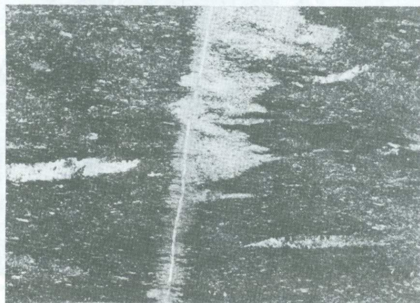
Рис. 7. Замещение сланца пиритом (светлое). Пришлифованный штуф, протравленный HF и \text{HNO}_3 . Увел. 4.
