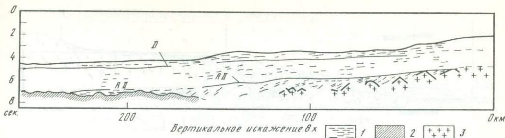
Рис. 87. Строение пассивной окраины к юго-западу от Южной Африки по данным многоканального сейсмического профилирования [Austin, Uchupi, 1982]
