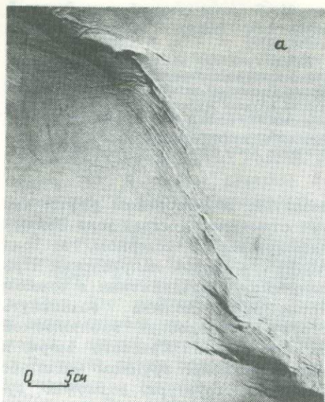
Рис. 84. Моделирование деформации в зоне зарождающегося трансформного разлома [по Courtillot et al., 1974]. На рисунке видно образование системы кулисно ориентированных трещин в слое глины (фото, a ) над жесткими пластинами, перемещающимися по типу левого сдвига (схема, б ). Сегменты AB и CD отвечают рифтовым зонам, сегмент BC — зоне трансформного разлома
