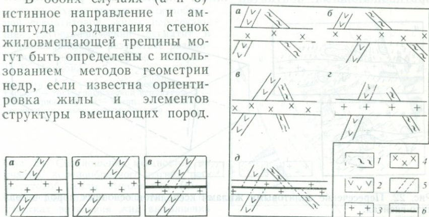
Рис. 20. Варианты косою пересечения пегматитовой жилы более древней дайкой. По Г. Гудспиду (Goodspeed, 1940).
