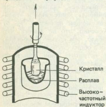
Рис. 5.3. Схема аппарата, используемого при вытягивании кристаллов из расплава, например, при синтезе ИАГ.
