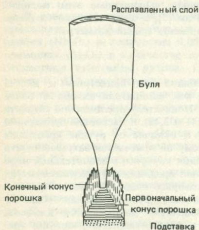
Рис. 5.2. Буля титаната стронция. Показано образование конуса порошка до и в процессе роста були.
