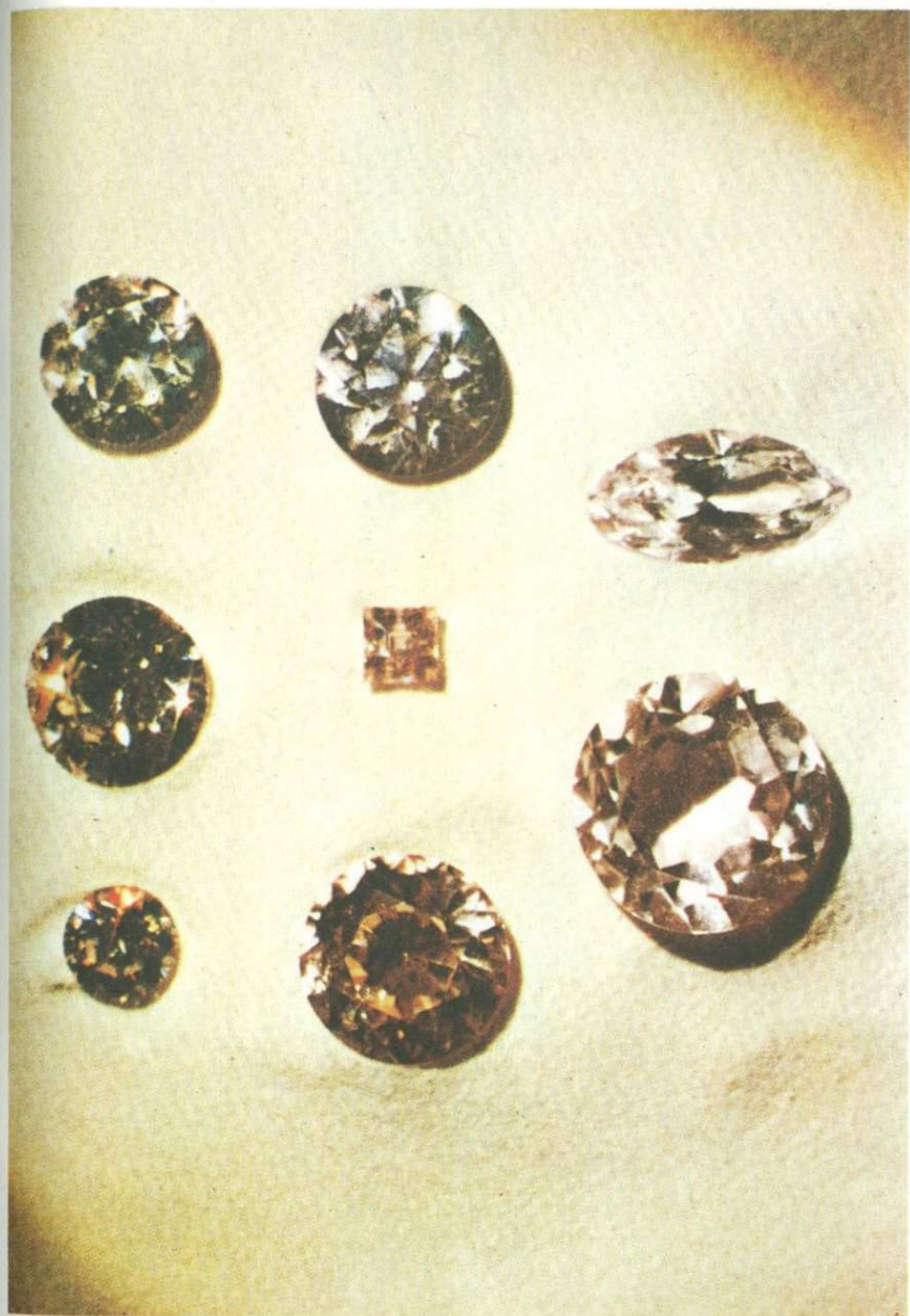
Рис. 5.6. Наиболее важные заменители алмаза. Верхний ряд (слева направо) — титанат стронция, кубическая окись циркония, ниобат лития. Средний ряд — ГГГ, барий-натриевый ниобат и танталат лития. Нижний ряд — шпинель и ИАГ.
