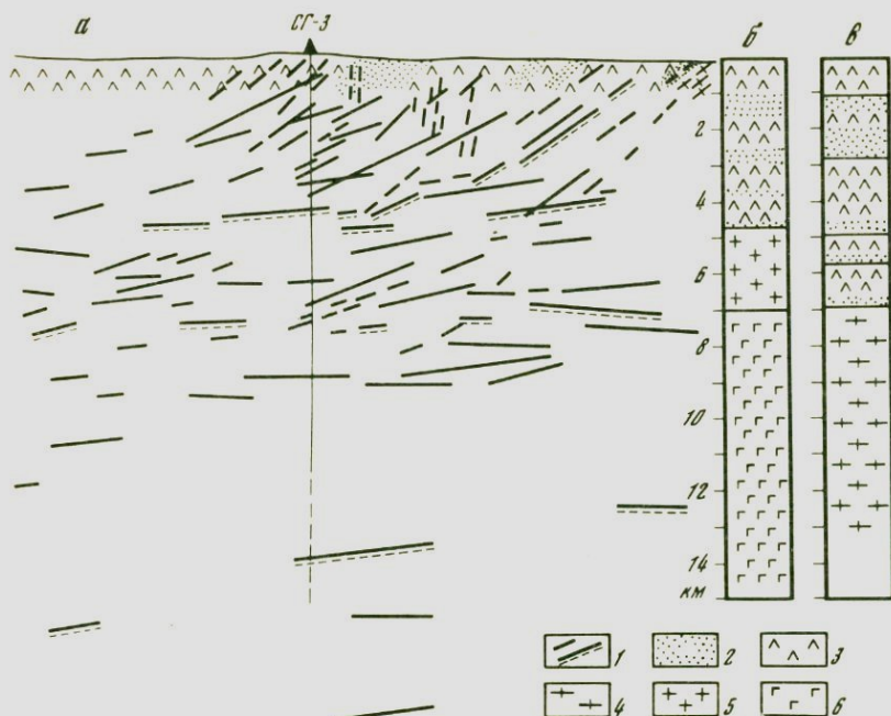
Рис. 43. Геолого-геофизические разрезы района заложения Кольской скв. СГ-3 а – сейсмический разрез по [64]; б, в – геологические разрезы: б – прогнозный, в – фактический 1 – отражающие площадки и сейсмические границы; 2 – метаосадочные породы; 3 – вулканогенные породы протерозойского комплекса; 4 – плагиогнейсы и гнейсы архейского комплекса; 5 – "гранитный" слой; 6 – "базальтовый" слой
