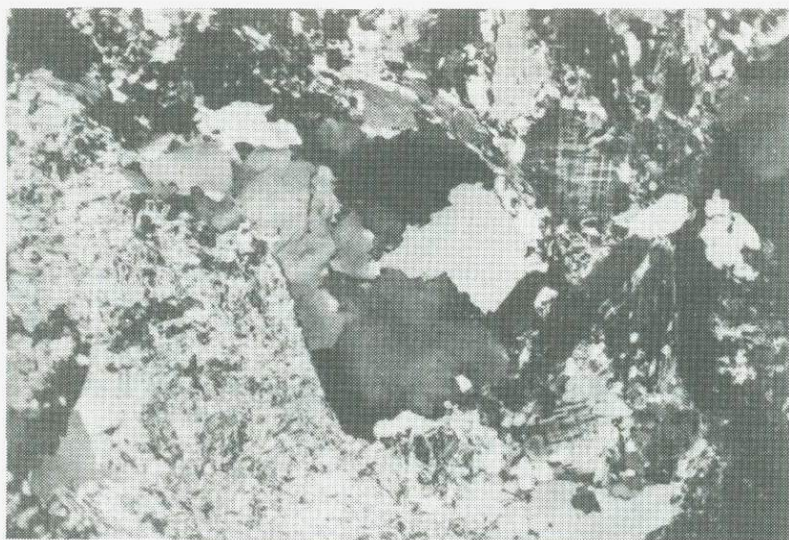
Рис. 13. Метаплагиогранит с реликтовой гипидиоморфнозернистой структурой; плагиоклаз "наполнен" мусковитом и эпидотом, кварц гранулирован, решетчатый калишпат свежий. Бескесский массив, балка Мощевая (обр. 819А)
