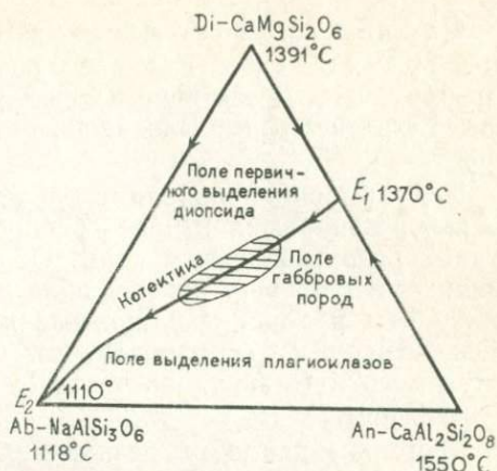
Рис. 31. Диаграмма, иллюстрирующая возможность выборочного выплавления базальтового эвтектоидного расплава в поле перidotитовых компонентов. По С. Д. Четверикову
