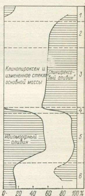
Рис. 41. Количественные соотношения различных структурных разновидностей оливина и вмещающей их основной массы в разрезе ультраосновного лавового потока из района Маунт-Клиффорд в Западной Австралии (см. рис. 40).
