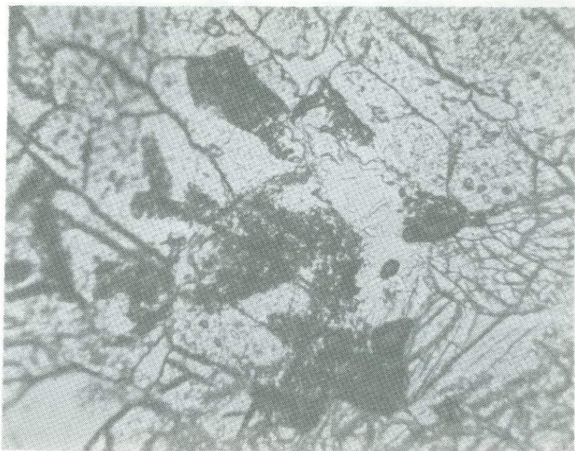
Рис. 2. Микрозернистый рутил (темно-серый) в псевдоморфных выделениях, сохранивших форму первичного титаномагнетита, в кристаллах граната. В кварц-омфацитовой массе он образует более крупные выделения (рельефные темно-серые удлиненно-округлые зерна). Эклогит из белорецкого комплекса. Ув. 170, ник. ||
