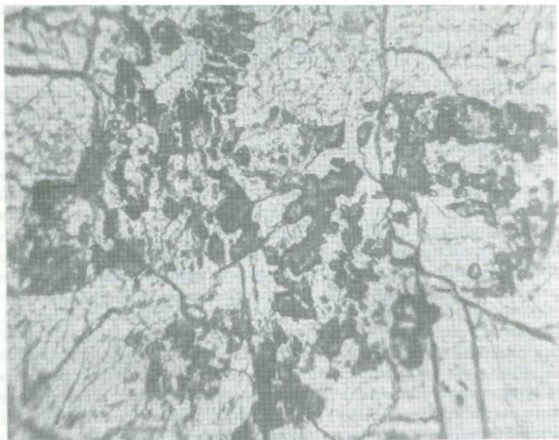
Рис. 1. Рутил (темно-серые рельефные зерна) в скоплениях, сохранивших форму и некоторые элементы ориентировки пластинок ильменита в структурах распада первичного титаномагнетита. Эклогит из белорецкого комплекса. Основная масса — гранит, омфацит и альбит-амфиболовый симплектит по омфациту. Ув. 190, ник. ||
