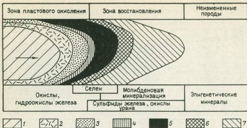
Рис. 14. Схема эпигенетической зональности в проницаемых отложениях.
