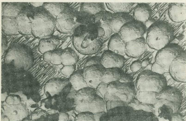
Рис. 41. Выделение коффинита по глобулям окислов урана. Электронная микрофотография ( \times 16\ 000 )
