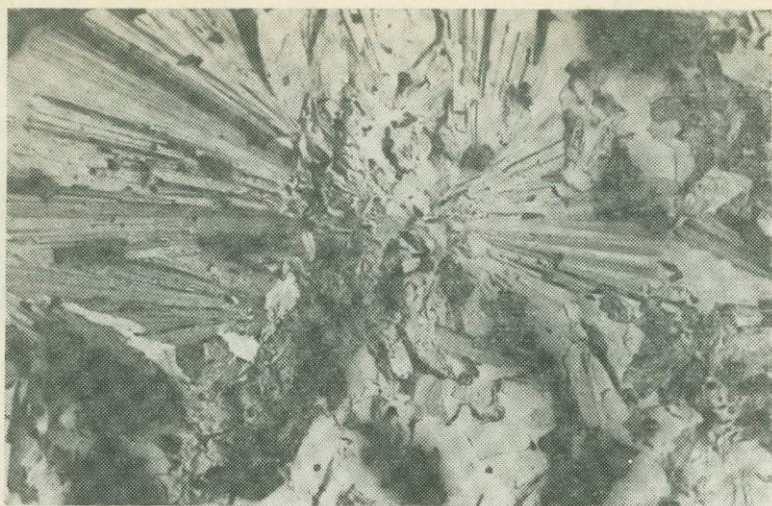
Рис. 37. Радиально-лучистое строение почки коффинита, вскрытое при ультразвуковом скальвании. Электронная микрофотография ( \times 15\,000 )
