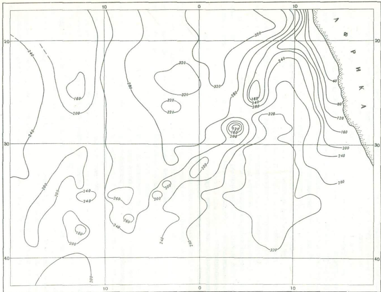
Рис. 2. Аномалии Гленни, осредненные по трапециям 1^\circ \times 1^\circ , над Китовым хребтом и прилегающими районами Южной Атлантики, сечение изолиний 40 мГал
