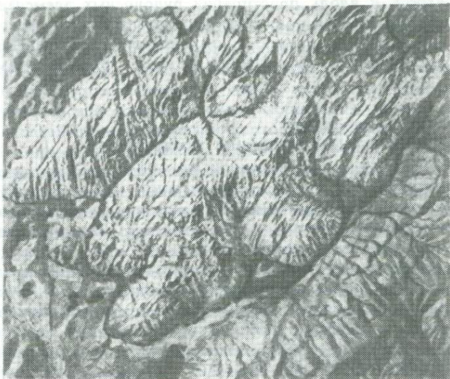
Рис. 48. Аэрофотоснимок незалесенной местности в масштабе 1:20 000—1:22 000. Гранитный массив (обведен штриховой линией) выделяется среди вмещающих песчаников и сланцев резкими формами рельефа [97]
