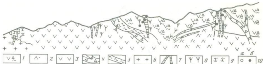
Рис. 6. Распространение бертьериновых и хлоритовых прожилков на схематическом разрезе через проявление галенитовой серебром минерализации в Кураминском поясе
