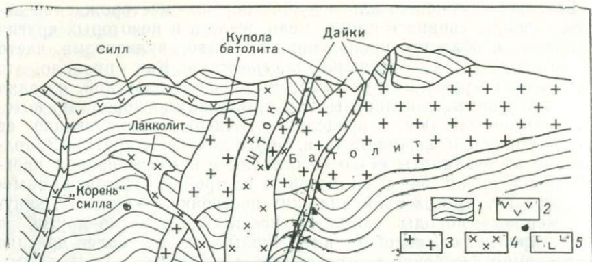
Рис. 18. Схематический разрез, иллюстрирующий форму различных интрузивных тел и преимущественно наблюдаемую последовательность их образования: 1 — слоистые породы (осадочные, эффузивные, метаморфические); 2 — диабазы; 3 — граниты и гранодиориты; 4 — диориты, граниты, сиениты; 5 — диабазовые порфириты
