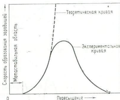
Рис. 8.9. Скорость зародышеобразования как функция пересыщения.
