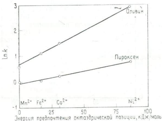
Рис. 6.18. Соотношение коэффициентов распределения четырех ионов переходных металлов между кристаллом и основной массой для оливина и клинопироксена в пикрите.
