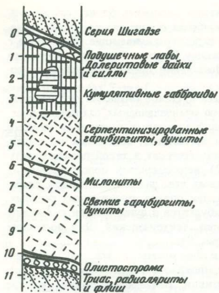
Рис. 9. Схематический разрез офиолитового комплекса Шигадзе [507]
