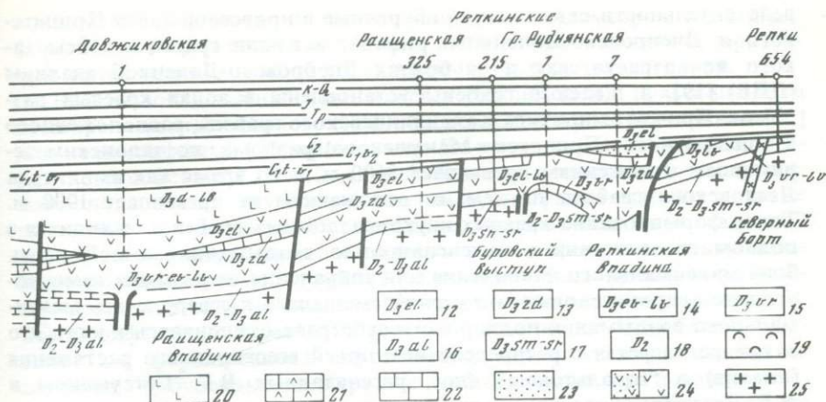
11—18 — девонские отложения: 11 — данково-лебедянские, 12 — елецкие, 13 — задонские, 14 — свлаовско-ливенские, 15 — воронежские, 16 — алатырские, 17 — семилукско-саргавские, 18 — средне-девонские; 19 — соль нижняя; 20 — соль верхняя; 21 — ритмичное переслаивание известняков, ангидридов, мергелей и аргиллитов; 22 — карбонатно-глинистые отложения; 23 — разнозернистые песчано-глинистые; 24 — кислые и основные эффузивно-туфогенные образования; 25 — докембрийские гранито-гнейсы
