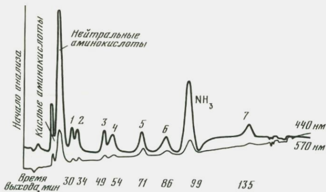
Рис. 20. Хроматограмма 6 — стандартная смесь основных аминокислот и аминоксахаров (содержание каждого компонента 12 нМ) 1 — Тир — тиразин; 2 — Фен — фенилаланин; 3 — Гл N — глюкозамин; 4 — Гал N — галактозамин; 5 — Лиз — лизин; 6 — Гис — гистидин; 7 — Арг — аргинин
