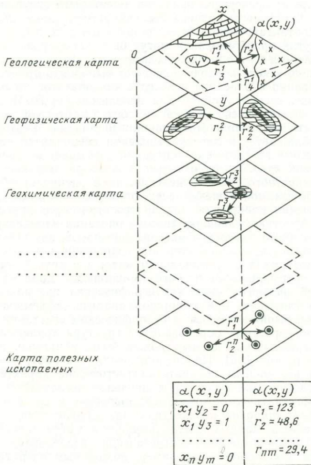
Рис. 7. Схема хранения картографической информации в территориальном машинном банке данные (по В. В. Марченко)
