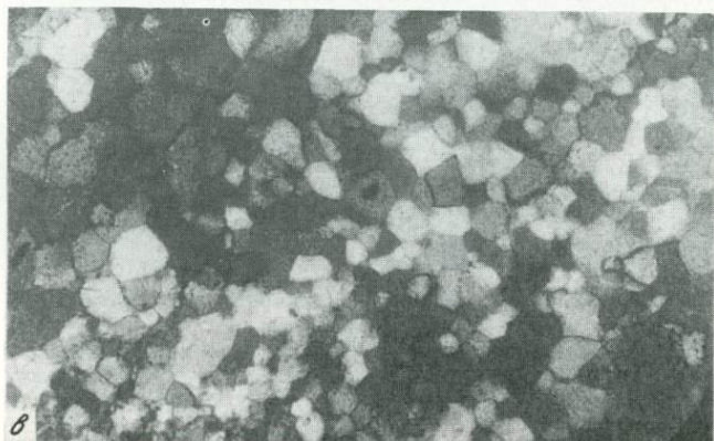
Т а б л и ц а V. Рекристаллизация природного пластически деформированного кварцита в условиях опыта
