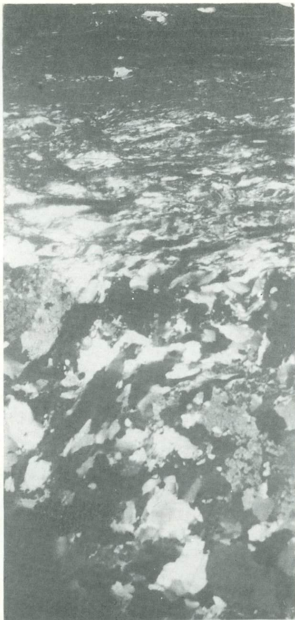
Т а б л и ц а XIII. Природная пластическая деформация кварцита, шлиф 477; увел. 6, николи скрещены
