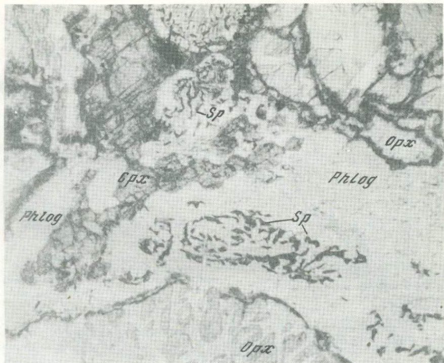
Рис. 6. Обильные графические вросстки шпинели в крупных пластинках флогопита В краевой части кристалла флогопита расположена цепочка зерен Стр-диопсида. Без анализатора, увел. 45
