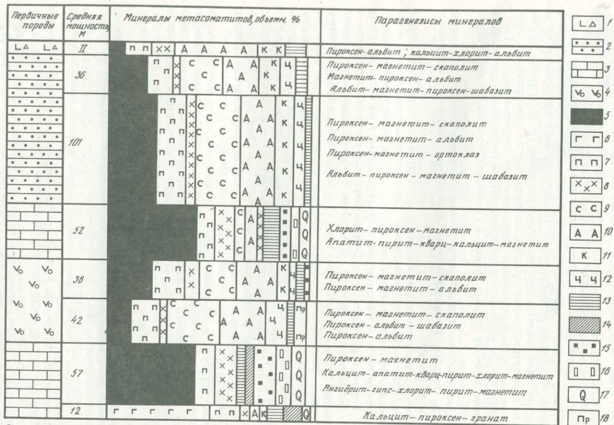
Рис. 3. Схема метасоматической зональности Северного участка Качарского месторождения 1 — вулканические брекчии полиморфных андезитовых порфиритов; 2 — красноцветные песчаники; 3 — известняки; 4 — мелкоблочечные вулканические туфы андезитовых порфиритов; 5-18 — минералы метасоматитов: 5 — магнетит, 6 — гранат, 7 — пироксен, 8 — хлорит, 9 — скаполит, 10 — альбит, 11 — ортоклаз, 12 — цеолиты, 13 — кальцит, 14 — ангидрит, 15 — пирит, 16 — апатит, 17 — кварц, 18 — пренит
