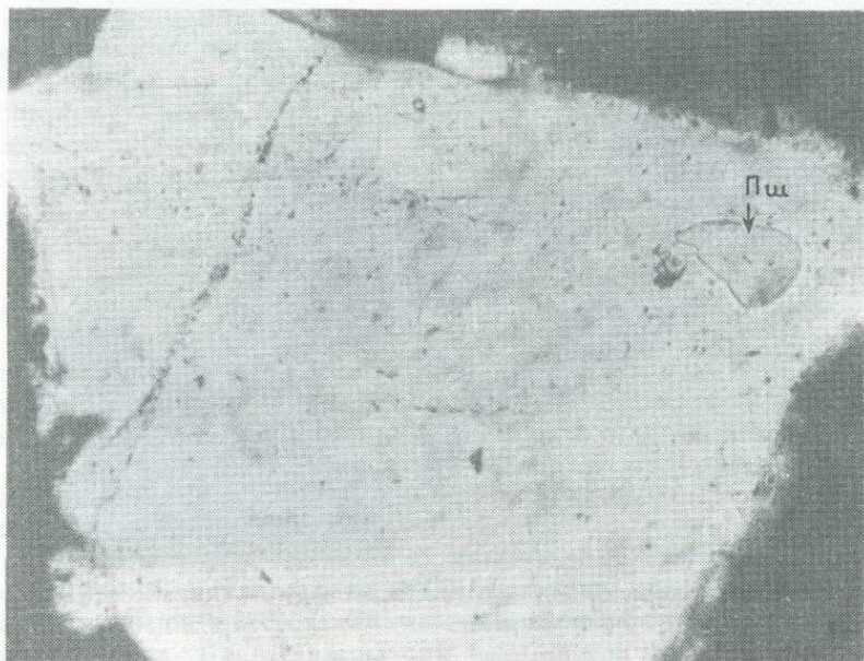
Рис. 50. Включение полевого шпата (Пш) в зерне кварца из каменноугольных отложений. Без анализатора, ув. 200
