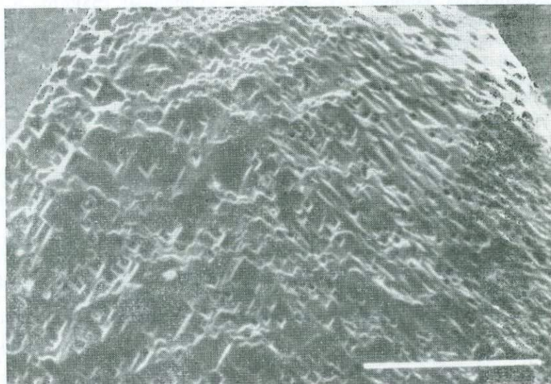
Р и с. 35. Микрофотография под сканирующим электронным микроскопом ямок травления на поверхности граната, с которой удалена келифитовая кайма, трубка Эксельсиор, ЮАР. Длина масштабной линейки 500 мкм.
