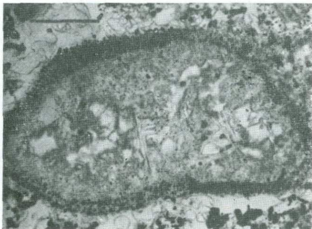
Рис. 39. Микрофотография микроксенолита глинистого сланца, подвергшегося метасоматозу и замещенного агрегатом кальцита, флогопита и перовскита, трубка Монастери, ЮАР. Длина масштабной линейки 0,5 мм; при одном никеле.
