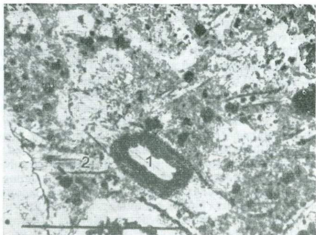
Рис. 37. Слюды типа I (1) и типа II (2) в кимберлите трубки Хололо, Лесото. Слюда типа I сильно изменена в результате реакции с кимберлитовой основной массой и окружена каймой, содержащей большое количество темного магнетита; измененные края кристалла выглядят чисто-белыми в отличие от коричневого ядра кристалла. Слюды обоих типов содержат включения рудных минералов основной массы. Длина масштабного отрезка 1 мм; при одном никеле.
