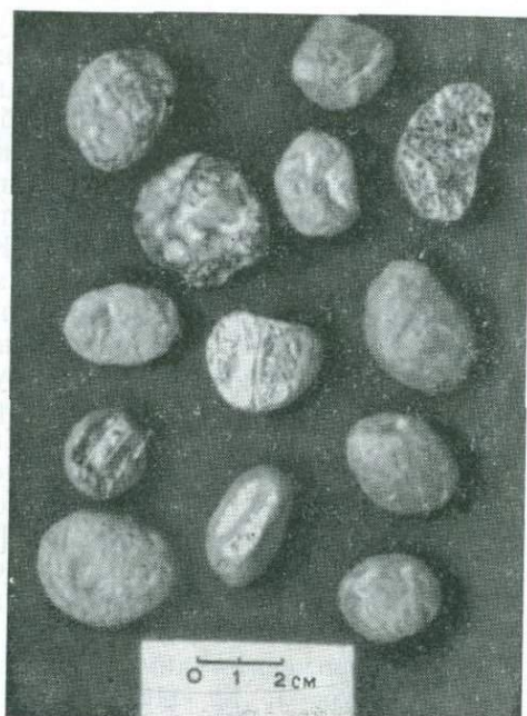
Рис. 25. Мегакристаллы ильменита из кимберлита трубки Таба-Путсоа, Лесото. Видны округлая форма зерен, внешняя коррозия и внутренняя пористость.
