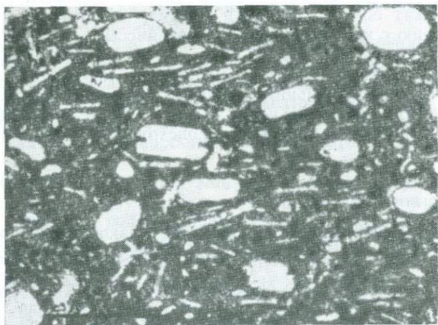
Рис. 32. Микрофотография трахитовой структуры, образованной пластинчатыми кристаллами кальцита в кимберлитовом потоке вулкана Игвиси-Хиллс, Танзания. Крупные кристаллы со сглаженными очертаниями — оливин. Длина масштабной линейки 2 мм; при одном николе.
