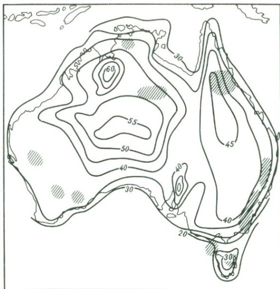
Рис. 56. Положение вольфраморудных регионов (штриховка) по отношению к участкам земной коры с повышенной мощностью (изолинии) на территории Австралии. С использованием материалов Н.А. Беляевского
