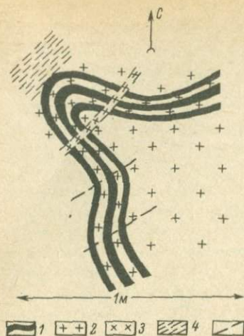
Рис. 2. Схема обн. 414. Зона перекристаллизации, секущая ядро складки F_3 . 1 - диопсид-амфиболовый кристаллический сланец; 2 - биотитовый плагиогранит; 3 - гиперстенный плагиогранит с ортоклазом зоны перекристаллизации; 4 - двупироксен-биотитовый гнейсо-гранит из зоны вторичного расланцевания D_4 ; 5 - ориентировка осевых плоскостей открытых складок F_7 .
