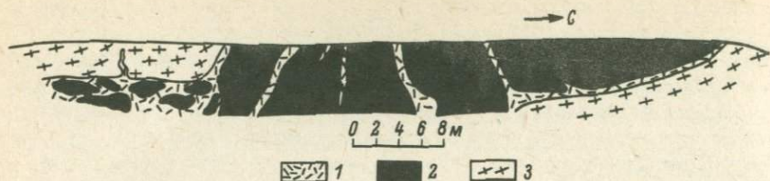
Рис. 2. Взаимоотношения основных пород с пегматитами и плагиогранитами. Западный борт выемки дороги у прол. Широкая Салма. 1 - пегматиты; 2 - основные породы; 3 - плагиограниты.
