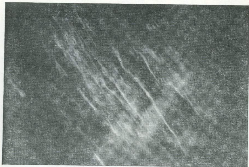
Рис. 17. Аномальное двупреломление синтетической шпиннели
