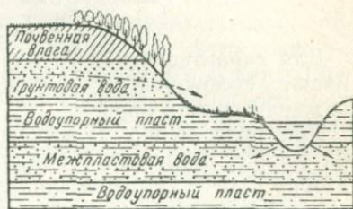
Рис. 11. Схема залегания грунтовых и межпластовых вод
