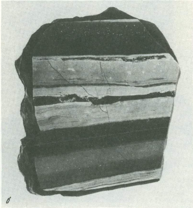
Рис. 59. Рудная брекчия и пирит-сидеритовая руда Озерного месторождения
