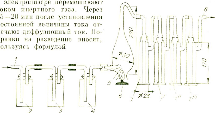
Рис. 4.3. Прибор для сжигания остатков хлорорганических инсектицидов. 1 — ввод для воздуха; 2 — 30%-ный раствор \text{NaOH} ; 3 — 10%-ный раствор \text{CuSO}_4 ; 4 — склянка уравновешивания давления; 5 — водовод лампы для сжигания со шпифом; 6 — резервуар лампы для сжигания со шпифом, куда вводится раствор сжигаемого вещества; 7, 7', 7'', 7''' — склянки Дресделя (в первых трех — по 3 мл 0,1 н. раствора \text{NaOH} и по 15 капель 3%-ной перекиси водорода, четвертая — пустая); 8 — трубка, присоединяемая к насосу.
