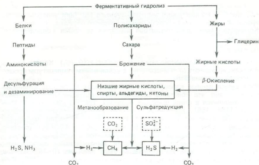
Рис. 2.3. Схема анаэробного ферментативного распада основных групп ОВ по С.С. Беляеву [137]
