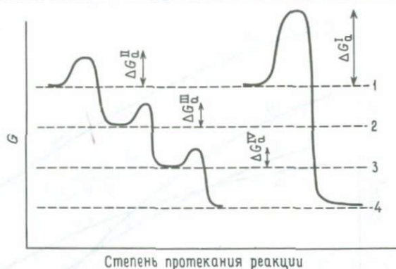
Рис. 5.9. Иллюстрация правила ступеней Оствальда. Прямое превращение из состояния 1 в состояние 4 связано с большой энергией активации ( \Delta G_I ) и может быть очень замедленным. Превращение через серию ступеней связано с меньшими энергиями активации и может оказаться кинетически более выгодным.
