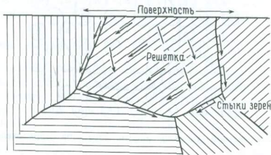
Рис. 1.10. Пути поверхностной диффузии, диффузии вдоль границ зерен и объемной диффузии (сквозь решетку).
