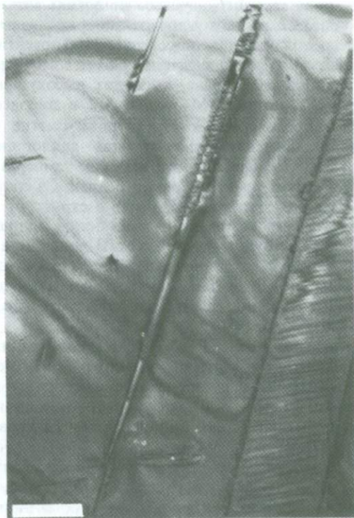
Рис. 7.14. Электронная микрофотография авгита, содержащего пластинки выделившегося пижонита. Структура поленицы в пластинках пижонита может быть предшественником образования при низких температурах ортопироксена – стабильной низкотемпературной фазы. Длина масштабной полоски 1,0 мкм. (По Чемпнессу и Копли, 1976, фото любезно предоставлено Чемпнессом.)
