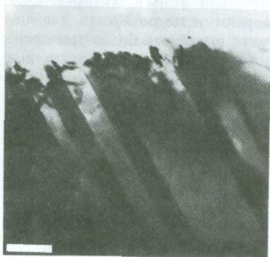
Рис. 1.6. Электронная микрофотография в проходящем свете, показывающая дифракционный контраст при тонком двойниковании в кубаните \text{CuFe}_2\text{S}_3 . Длина масштабного отрезка 0,2 мкм.
