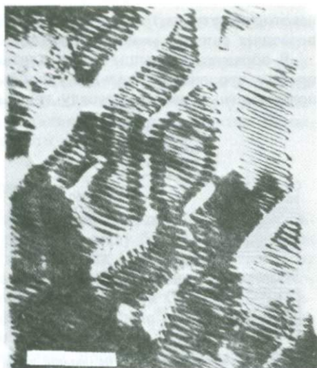
Рис. 8.6. Электронная микрофотография криптопертита с зигзагообразными границами раздела между тонко сдвойникованным натровым полевым шпатом и калишпатовой матрицей. Длина масштабной полоски 0,2 мкм. (Фото любезно предоставлено Уиллэймом.)
